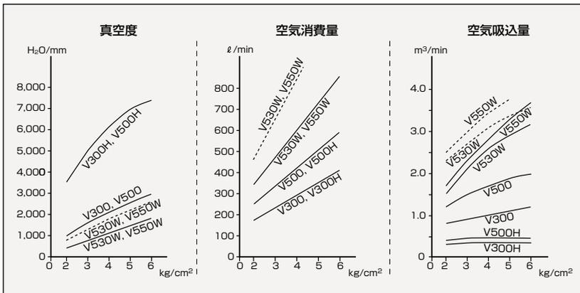
\*図中の点線 V530W, V550W はエアバルブ 1 / 2' を使用した時。
