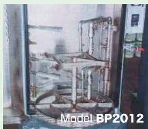
洗浄機内のワークの水切り
