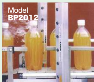
プラスチックボトル洗浄後の水切り
