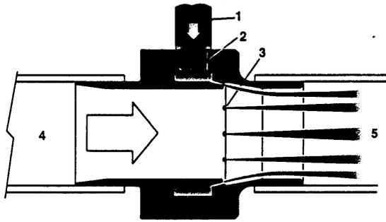
圧縮空気①をチャンパー②よりノズル③より管内に放出することにより、周囲の空気（大気）を引き込み、大量な空気となって吐出されます。吸引側と吐出側の口径が同じになっていますので、配管途中に取り付けが簡単です。空気移送用のパーツとして最適です。空気の吐出（移送）速度は、供給空気圧の調整にて簡単に行えます。材質はアルミとステンレスの2種類があります。
